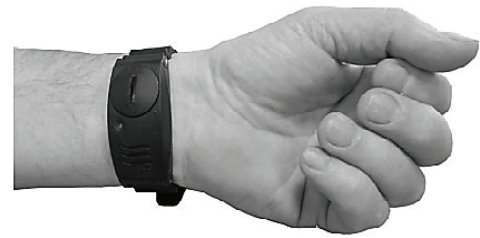
Рис. 1. Носимая часть телемеханической системы контроля бодрствования машиниста на руке
